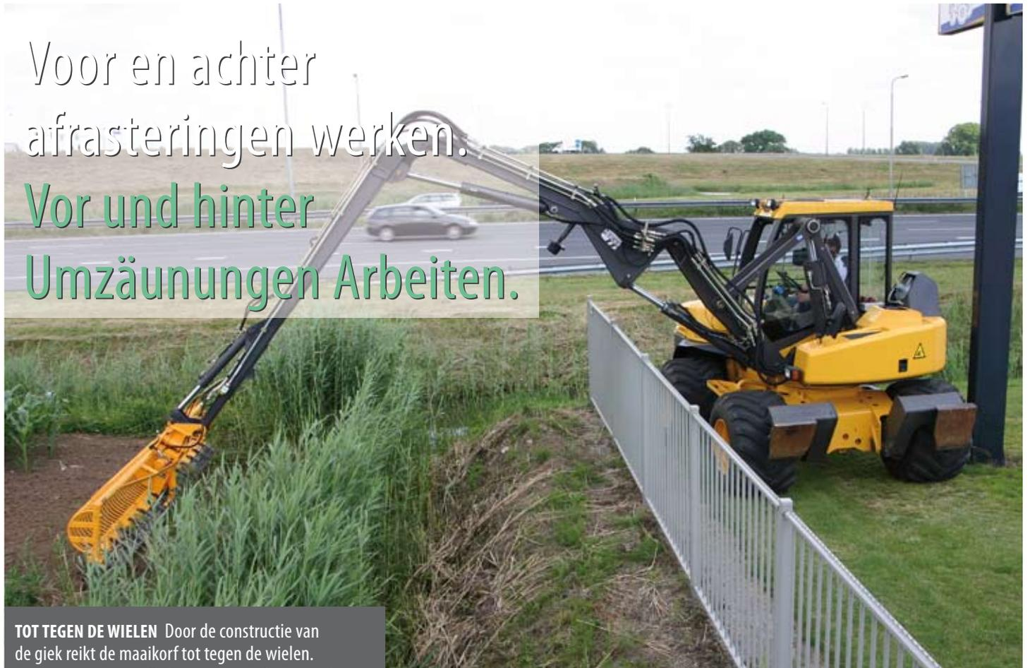
**TOT TEGEN DE WIELEN** Door de constructie van de giek reikt de maaikorf tot tegen de wielen. **MATERIAAL LOSSEN** Zo kan over een afrastering heen gewerkt en tussen de machine en afrastering gelost worden. **SNEL EN VER** Snel kortbij en veraf werken door met één bediening 2 cilinders tegelijk aan te sturen. **VARIABELE SNELHEID** Inching-functie voor langzaam en nauwkeurig rijden.
